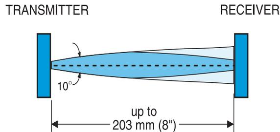
TRANSMITTED BEAM  EFFECTIVE RECEIVED BEAM
